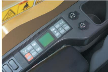
**Consola.** Los tableros se caracterizan por ser de diseño funcional y simple, por reducir la fatiga del operador, facilitar la operación de los interruptores y tener una excelente visibilidad. Ambas consolas disponen de posabrazos incorporados con ajustes de altura.
