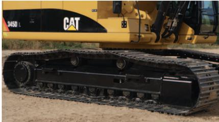
**Opciones de tren de rodaje.** La cadena con pasadores de retención firme (PPR2) y ruedas guía fundidas están disponibles como accesorios en la 345D L. La cadena PPR2 evita que se afloje el pasador de cadena del eslabón, y la rueda guía fundida está diseñada para tener una vida útil prolongada. Ambas opciones son ideales para aplicaciones extremas o para aquellas que requieren una gran cantidad de desplazamiento.
