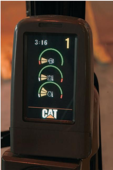
**Pantalla del monitor.** La pantalla de cristal líquido (LCD) compacta, a color, de 400 x 234 píxeles, muestra información de mantenimiento, diagnóstico y pronóstico de la máquina en 27 idiomas diferentes. El teclado permite al operador seleccionar las condiciones de funcionamiento de la máquina y las lecturas que desea ver en la pantalla. La lámpara de advertencia maestra se ENCIENDE y APAGA cuando ocurre una de estas condiciones críticas:
