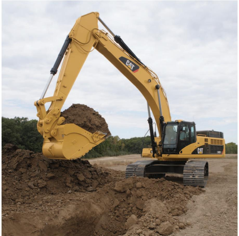
**Prioridad de la pluma y del giro.** El sistema hidráulico de la 345D L proporciona función de prioridad automática para las operaciones de subida y giro de la pluma, eliminando la necesidad de botones en la modalidad de trabajo. Cuando se activa la pluma o la palanca de giro, el sistema asigna automáticamente la prioridad basado en la demanda del operador.
