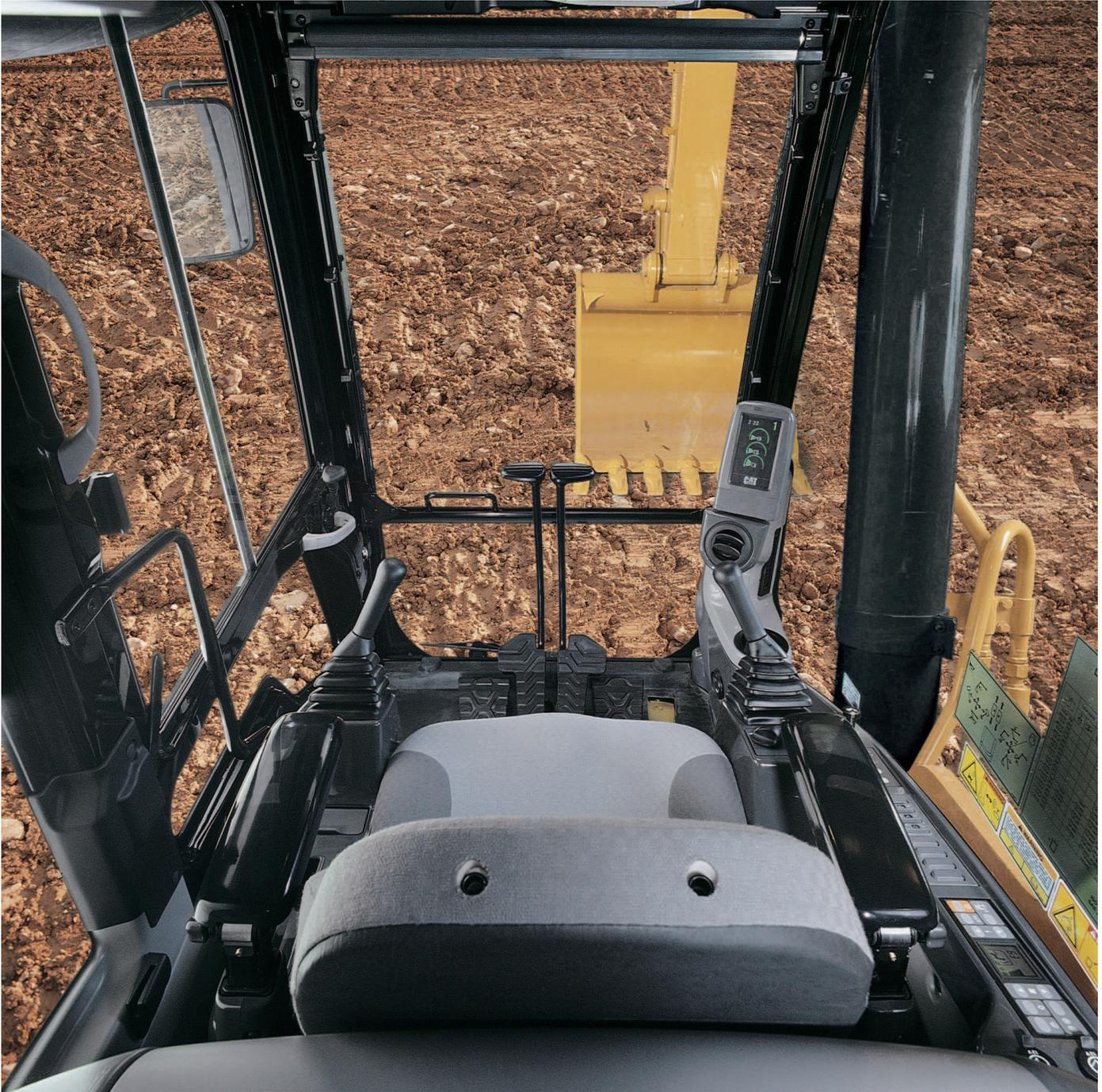
**Diseño de la cabina.** La estación de trabajo es espaciosa y silenciosa, lo que asegura alta productividad durante todo el turno de trabajo. Los interruptores del aire acondicionado y del accesorio están ubicados convenientemente en la pared del lado derecho y el interruptor de arranque con llave y el selector de aceleración están en la consola del lado derecho. El monitor tiene excelente visibilidad.
